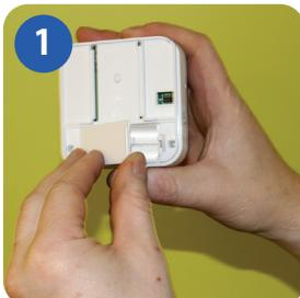
Снимите крышку батарейного отсека на задней стенке iT300 блока.
