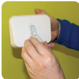
Для настольного использования термостата, просто защелкните дополнительный упор (подставку) к задней панели устройства.
