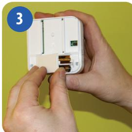
Закройте крышку батарейного отсека..
