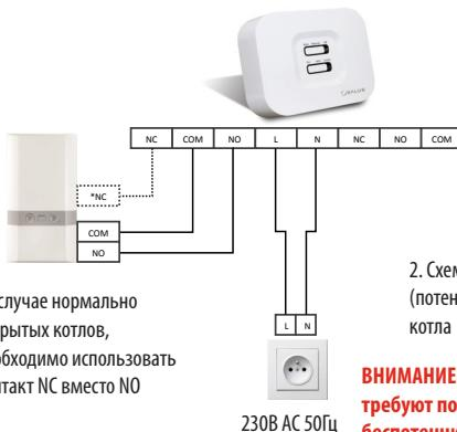
2. Схема подключения с использованием одной зоны нагрева (потенциальное реле) в случае подключения циркуляционного насоса и котла
