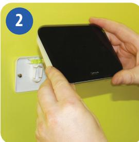
Убедившись, что кронштейн надежно закреплен, зафиксируйте iT500. Для этого сначала совместите паз на задней панели устройства с кронштейном и защелкните его в установочном месте.
