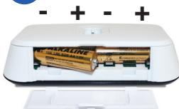
Вставьте вторую батарею в левую часть отсека.
