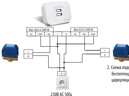
2. Схема подключения с использованием двух зон отопления - беспотенциальное подключение котла и потенциальное подключение циркуляционного насоса или двухходового клапана.
