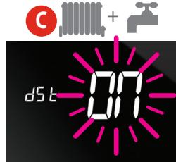
Нажимая на символ включаем (ON) или выключаем (OFF) функцию dSt.
