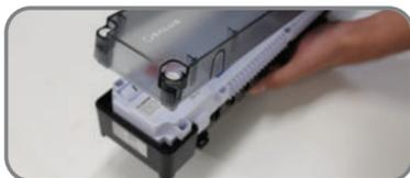
**2** Снимите белую соединительную панель.
