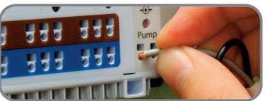
**10** Подсоедините провода к соответствующим коннекторам управления котлом. Используйте стык в котле, предназначен для подключения комнатного термостата.
