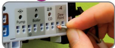
**13** Обеспечьте безопасность подключения проводов, используя монтажные принадлежности, поставляемые вместе с центром коммутации.
