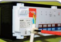
**8** Подсоедините провода сервоприводов к соответствующей зоне блока коммутации (до 3-х сервоприводов на каждый терморегулятор).
