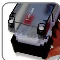
**2** Снимите белую соединительную панель.
