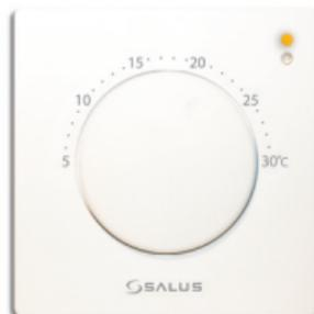
Ни зеленый, ни красный диод не горят когда VS10 удерживает экономичную температуру (VS10 - Ведущий Группой Регуляторов, а VS05 - часть группы) В этом случае VS05 работает в режиме ночного понижения температуры. Например, если на регуляторе установлено темп. 22°C, а температура ночного понижения установлена на 4°C, тогда заданная на VS05 температура выносит 18°C.
