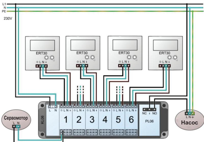
Каждая секция подключение к 4 сервомоторам.
