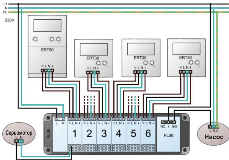
Каждая секция подключение к 4 сервомоторам.
